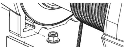
4. Установите четыре (4) гайки с фланцами в углубления на опорах лебедки.
