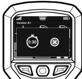
5. В течение этого 30-секундного интервала необходимо выключить, а затем снова включить кнопку включения блока беспроводного дистанционного управления, расположенную на задней стенке блока управления лебедки.
