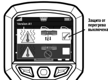
3. Чтобы включить функцию защиты от перегрева, при помощи кнопок Влево и Вправо выберите иконку отключения функции защиты от перегрева. В соответствующем окошке появится иконка с галочкой. Нажмите кнопку Выбор/Select.
