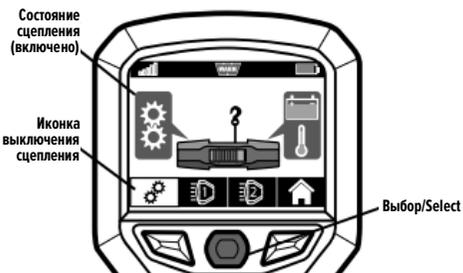
4. После выключения сцепления иконки с шестернями в полях состояния сцепления и выключения сцепления изменятся с «включено» (⚙) на «выключено» (⚙°).
