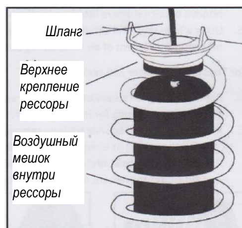
Рис. 2: Крепление воздушного мешка к рессоре
