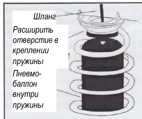
Рис. 1: Расширение отверстия под клапан для накачивания
