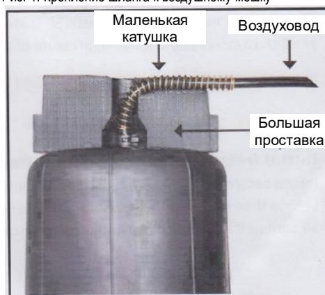
Рис. 2: Расположение проставки для поворота шланга на 90°
